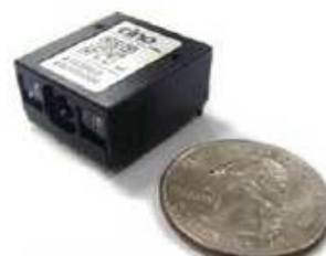
SE-380 1D條碼讀取引擎, 可適用於盤點機、KIOSK、以及內建條碼讀取功能的電子產品
